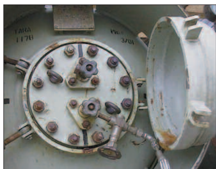
Modelo 2020 num reservatório de descarga de HCl a 80 bar - Grã-Bretanha
